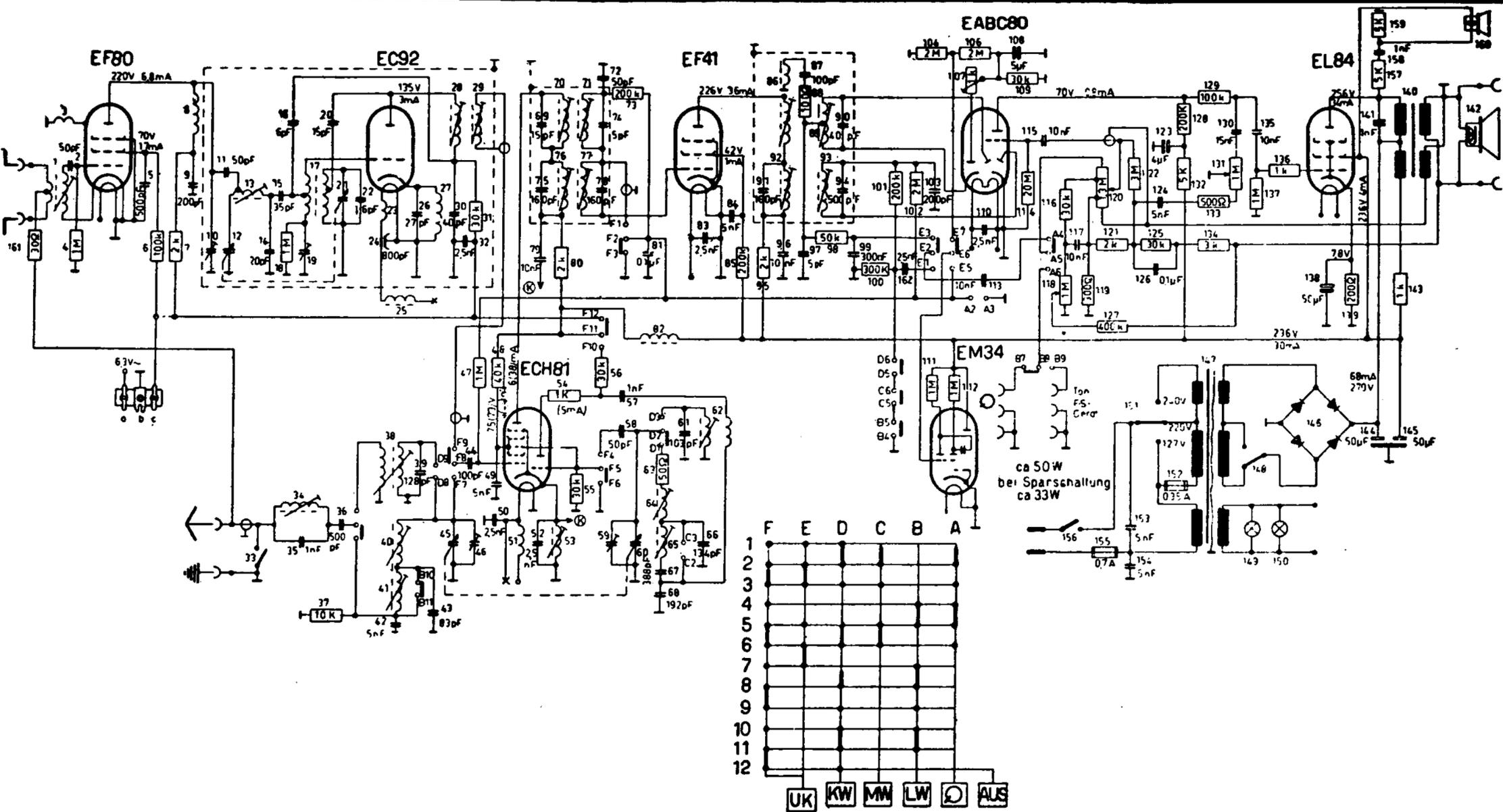
**GRAETZ-SICART (Graetz Radio und Fernsehwerke, Alena) - Mod. Super 171 W. Apparecchio AM/FM, con tre gamme d'onda a modulazione d'ampiezza (lunghe, medie e corte) e una a modulazione di frequenza (onde ultracorte). Punti di allineamento: per OL 200 kc/s, per OM 600 e 1440 kc/s, per OC 7 Mc/s, per FM 88,5, 93 e 98 Mc/s. Ampia gamma sonora con due altoparlanti, di cui uno elettrostatico. Controlli dei toni bassi e alti. Potenza d'uscita indistorta 4 watt. (Produzione 1955).**
